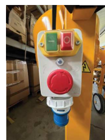
Quadro elettrico con termico e pulsante emergenza. Electrical panel with thermal and emergency button.
